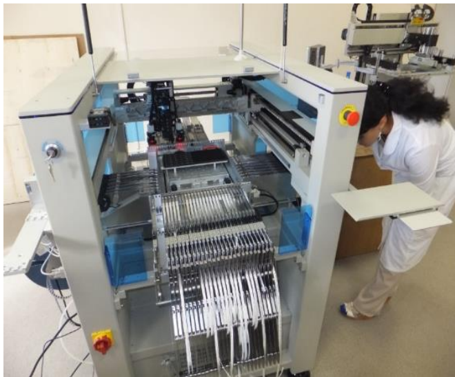
SMT автомат для производства интеллектуальных контроллеров
